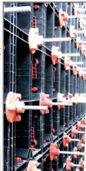
ОСНОВНОЙ ЭЛЕМЕНТ 120 X H 60 см (факт. размеры 121 x 60,5 см) МАТЕРИАЛ: ABS ВЕС 11 кг
